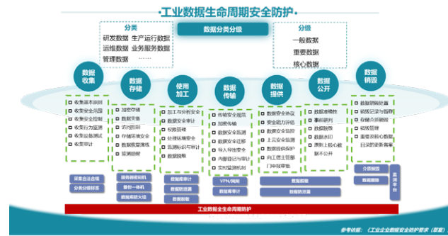
图4 工业控制系统数据安全防护架构
